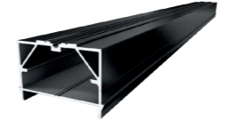
Alu-Unterkonstruktion L (Large) mit Schraubkanal pulverbeschichtet schwarz RAL 9005 seitlich gerippt, statisch belastbar, max. 1,10m Auflageabstand Mitte-Mitte 45 x 64 mm, 400 cm Länge einzeln
