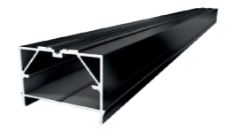
Alu-Unterkonstruktion M (Medium) mit Schraubkanal pulverbeschichtet schwarz RAL 9005 seitlich gerippt, statisch belastbar, max. 0,80m Auflageabstand Mitte-Mitte 30 x 64 mm, 400 cm Länge einzeln
