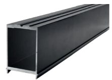
Alu-Unterkonstruktion MEGA Isostep mit Schraubkanal pulverbeschichtet schwarz RAL 9005 seitlich gerippt, statisch belastbar, extrem hohe Spannweite: Auflageabstand bis zu 300 cm 64 x 95 mm, 400 cm Länge einzeln
