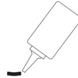
Das Klebesystem umfasst einen Wandkleber auf MS-Hybridpolymerbasis (erhältlich in 600 ml Beuteln) und einen dekorativen, transparenten Kleber zum Abdichten (zu beziehen als leicht zu handhabende 290 ml Kartusche). Der Wandkleber lässt trotz sofortiger Anfangshaftung ein Korrigieren des Boards an der Wand noch zu. Der Verbindungskleber sichert eine leichte Verarbeitung zu, hat sehr gute Dichteigenschaften und ist dauerelastisch.
